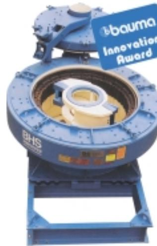
**Ο φυγόκεντρος σπαστήρας HSMX με κάθετο άξονα διατίθεται από την Μπούζα Α.Τ.ΕΒ.Ε και δέχεται πέτρωμα για θραύση με maximum ποσοστό χαλαζία 90-95%.**
