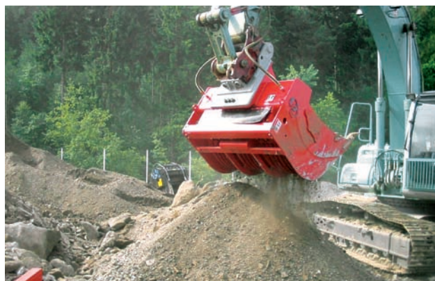
Zhodnocování skládky: na rypadle osazená třídící lžičce Rotar třídí jemné složky, vzadu je připravená drtící lžičce MB BF90.3
