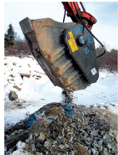
Drcení betonové suti lžicí Meccanica Breganzese BF 70.2 na 18t kolovém rypadle
