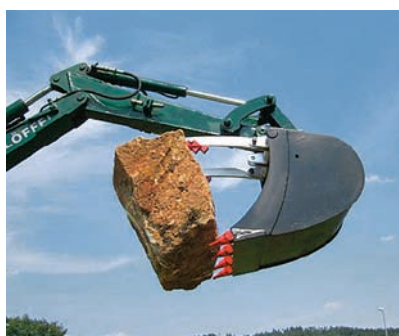
Speciální lžičce Holp Multigrip při bezpečné a pohodlné manipulaci s neforemným kusem
